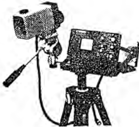
Рис. 3.11. Тепловизор типа AGA 750
