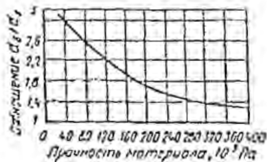
Рис. 6.10. Тарировочная кривая для определения прочности бетона молотком Кашкарова
