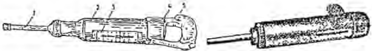
Рис. 6.11. Пистолет ЦНИИСКА и Рис. 6.12. Пружинный пистолет С.И. Борового для определения прочности бетона неразрушающим методом
