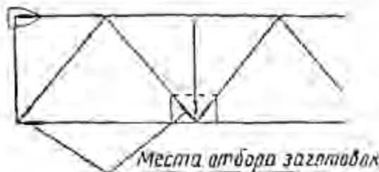
Рис. 8.6. Места отбора заготовок из элементов ферм
